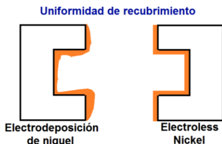
Figura 8. Diferencia en la uniformidad entre el níquel electrodepositado y el ENP. Fuente: elaboración propia.
