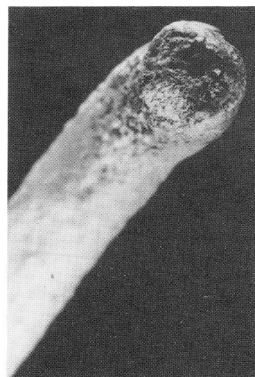
FIG. 41. — N° 1, ST 5. Vue détaillée de l'effet de compression de la partie active.
