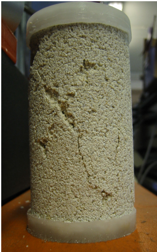
Eprouvette fissurée après l'essai mécanique
