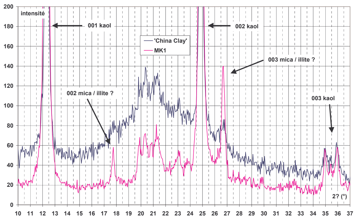
Figure 24 : Diagramme de rayons X des deux kaolinites
